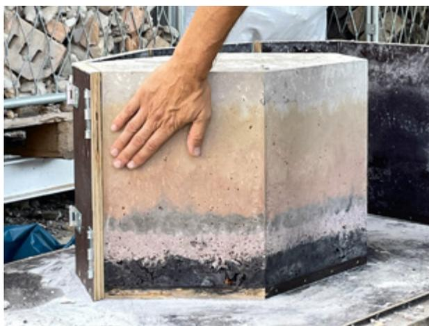
Recycelter Beton, hergestellt aus dem mineralischen Erbe des Spreeparks (Ziegel, Beton, Asphalt, vor Ort gefundene Natursteine wie Granit, Amphibolit, Gneis).
